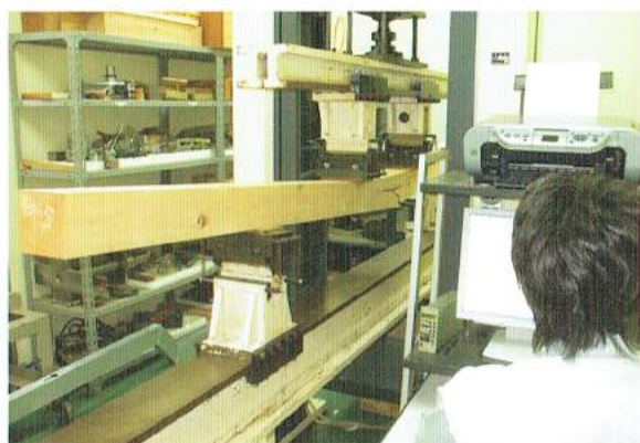
強度試験機による曲げヤング係数と曲げ強度の測定
